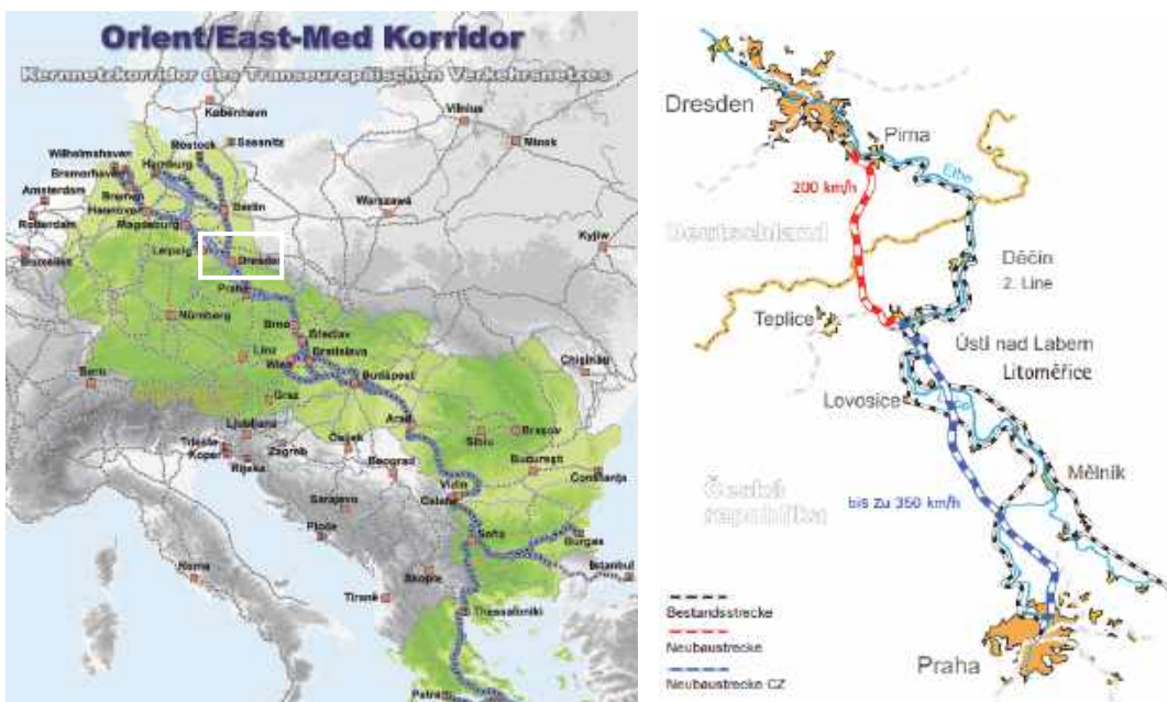
Fig. 1: Eisenbahn-Neubaustrecke Dresden-Prag im TEN-V-Korridor Orient / Östliches Mittelmeer
