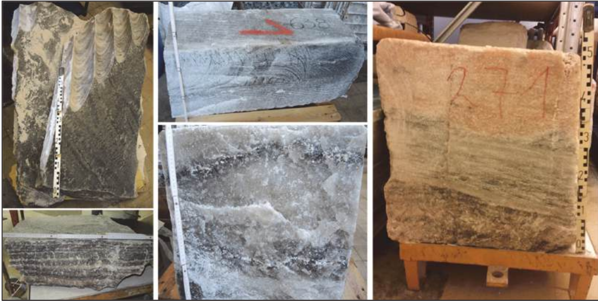
Abb. 1: Probenmaterial (v.l.n.r.): (Typ1) "Upper Salt" - Steinsalz mit Tonlöserhorizonten, (Typ2) Steinsalz mit diffuser Schichtung, (Typ3) Materialwechsel Carnallit auf Steinsalz
