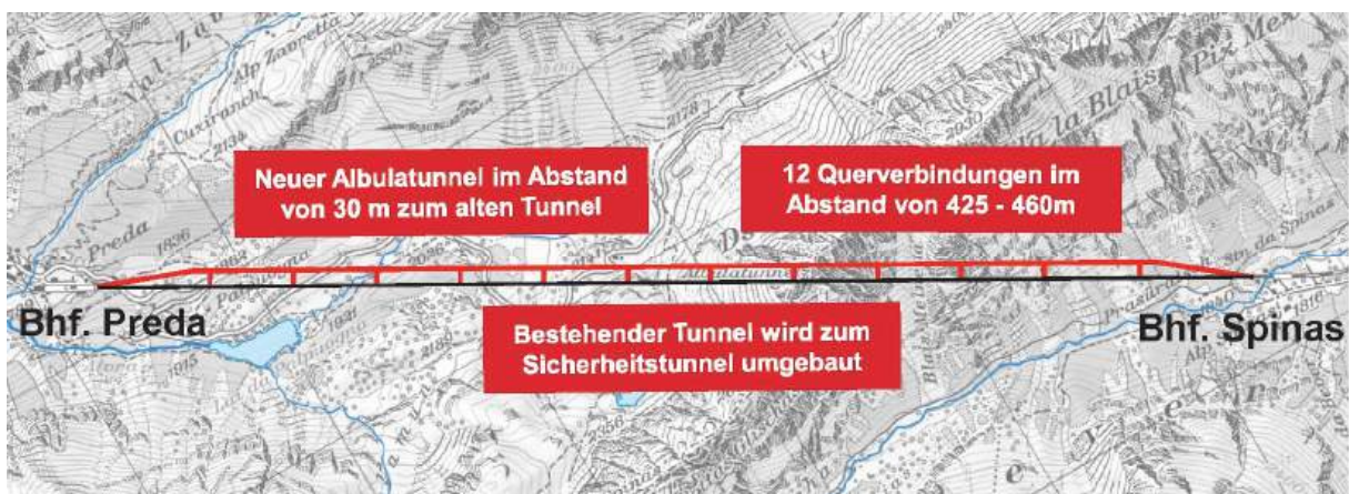
Fig. 4: Gesamtübersicht Albulatunnel I und II
