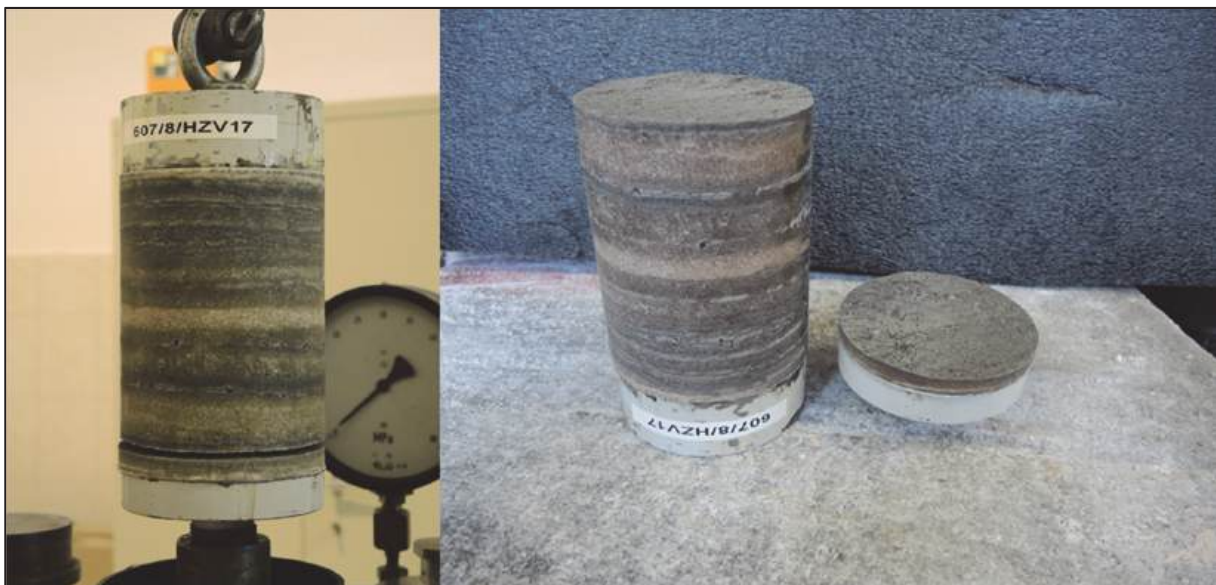
Abb. 5: Haftzugfestigkeit von Steinsalz mit Tonlöserhorizonten – Salzvarietät (Typ1) nach Versagen in einem Tonlöserhorizont
