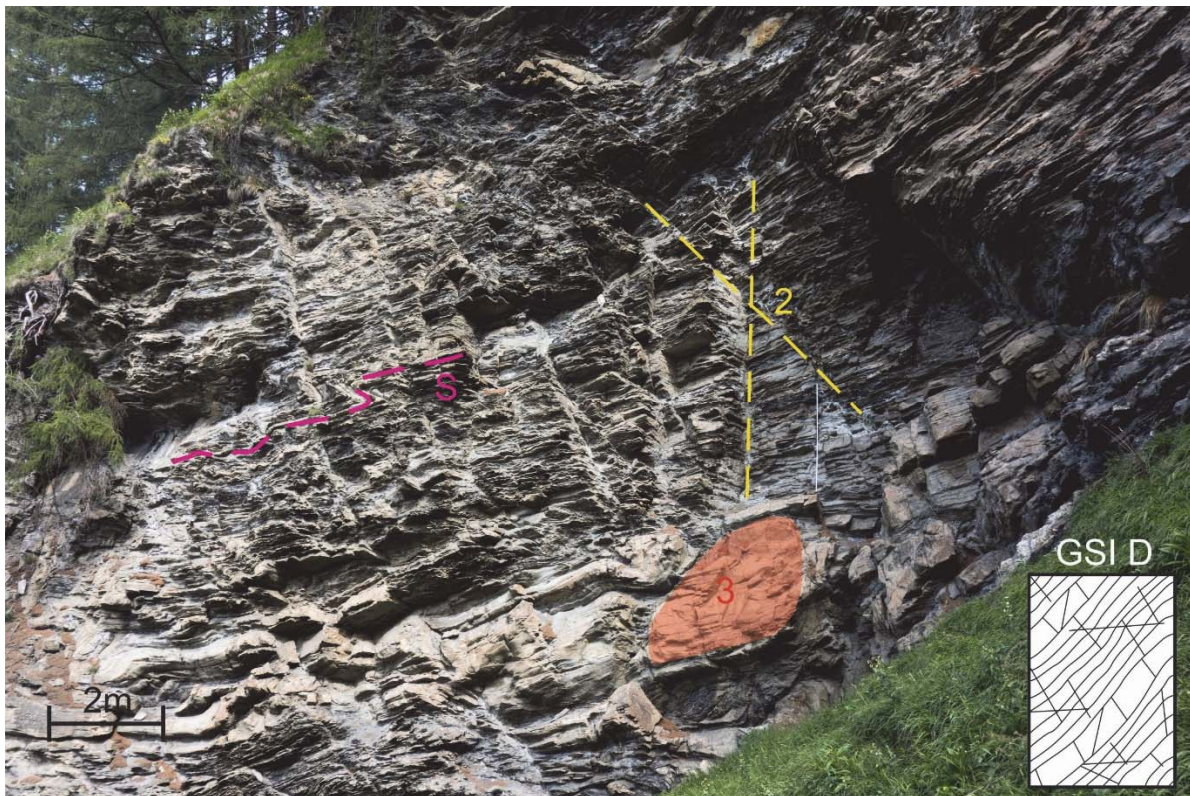
Abb. 3: repräsentativer Aufschluss für das stark gefaltete und geklüftete Gebirge des Bündner Schiefer im Valsertal: S-Schieferung (magenta), 2-konjugierte Diskontinuitäten (gelb), 3-Störungsfläche (rot) [1].
