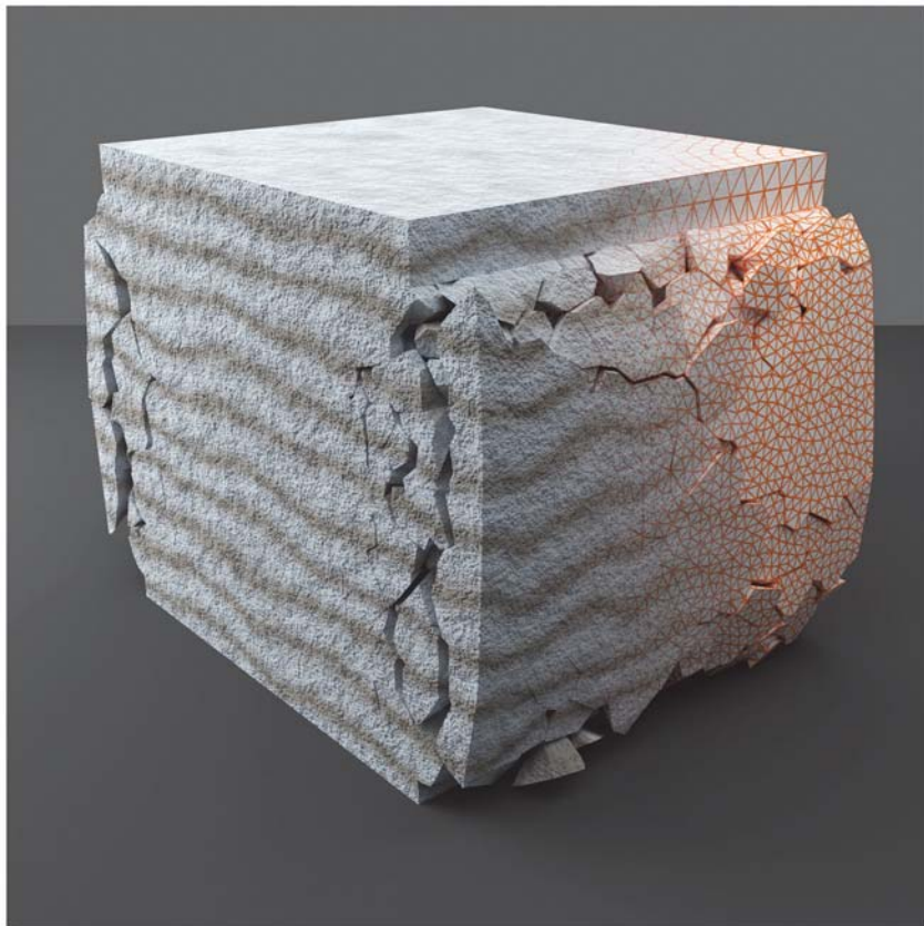
Fig. 3: Rissbildung und Abschalungen an einem diskontinuumsmechanischen Berechnungsmodell eines Steinsalzpfeylers.
