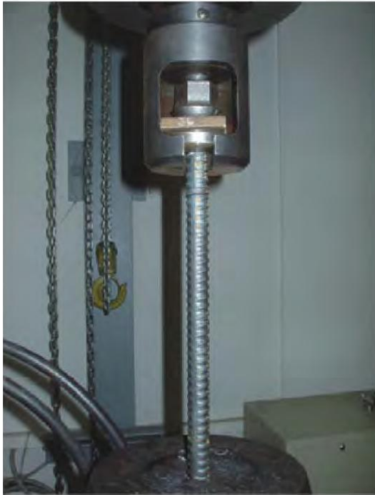
Fig. 6.1: Direct tension test of bolt (Frühwirt 2011)
